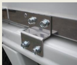
コンテナ取付 ステージ板
