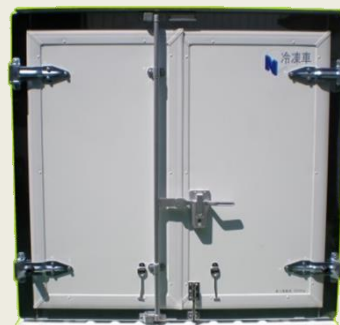
リア扉ロッドバー式観音扉 左先開き/右落とし錠
