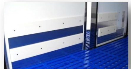
庫内壁面を衝突傷から守る アルミ板&エスウッド
