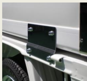
コンテナ取付 ステージ板
